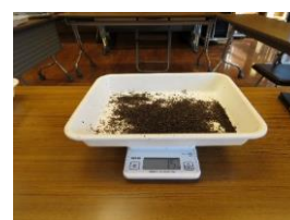
図 4: 乾燥重量計測の様子
