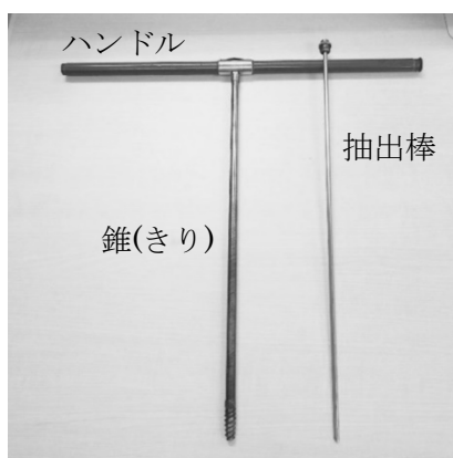
図 3. 成長錘、成長錘コアの採取方法
