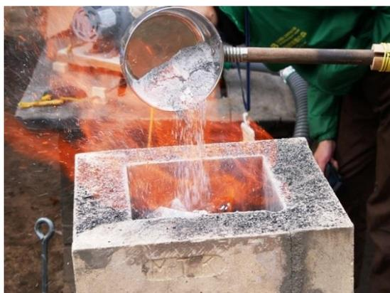
図 4 柄杓にて砂鉄投入(第 2 回)
