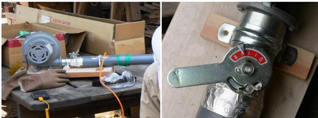
図 3 送風機、及び風量調整バルブ部
